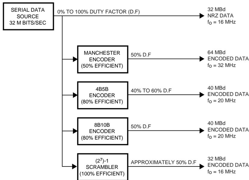
NOTE THAT  $f_0$  IS THE MAXIMUM FUNDAMENTAL FREQUENCY OF THE ENCODED DATA. THE MINIMUM FUNDAMENTAL FREQUENCY OF THE ENCODED DATA IS DETERMINED BY THE ENCODER'S RUN LIMIT.
